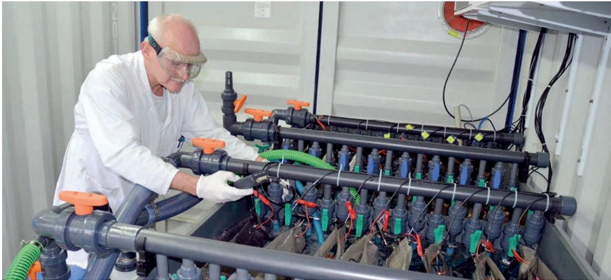
Prototyp einer Biobrennstoffzelle.
