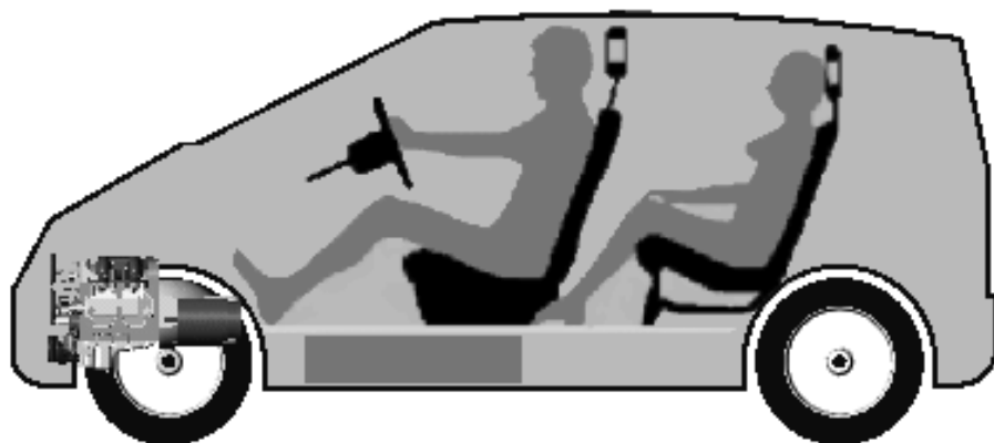
Bild 7: 1,0 l -Version eines Kurbelschlaufenmotors in einem Kleinwagen [4]
