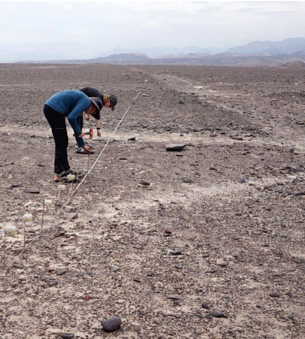
*Entlang der Nazca-Linien werden Geoelektrikprofile aufgebaut, um die Untergrundstrukturen zu erfassen.*
