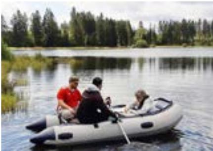
*Das Schlauchboot „Plesiosaurus“ ermöglicht tiefenorientierte Wasserentnahmen aus verschiedenen Schichten des Kiehhölzer Teiches.*
