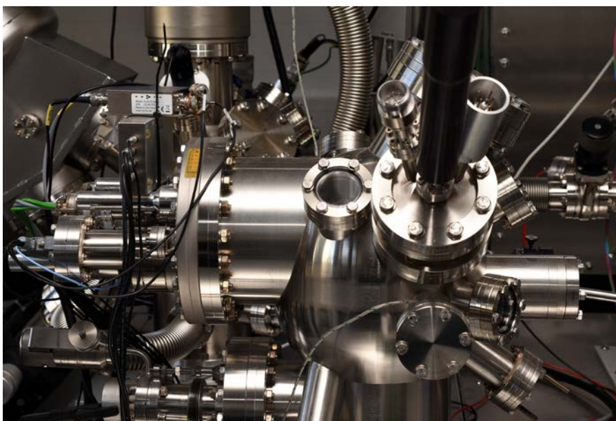
Photoelektronenspektroskopie-Anlage für in situ XPS-Experimente.
