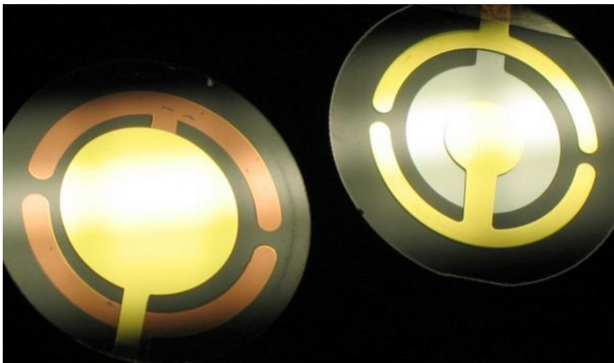
Die zentrale Komponente der Schwingquarz-Mikrowaage ist denkbar einfach. Es handelt sich um eine Scheibe aus kristallinem Quarz, die beidseitig mit Elektroden bedampft ist.
