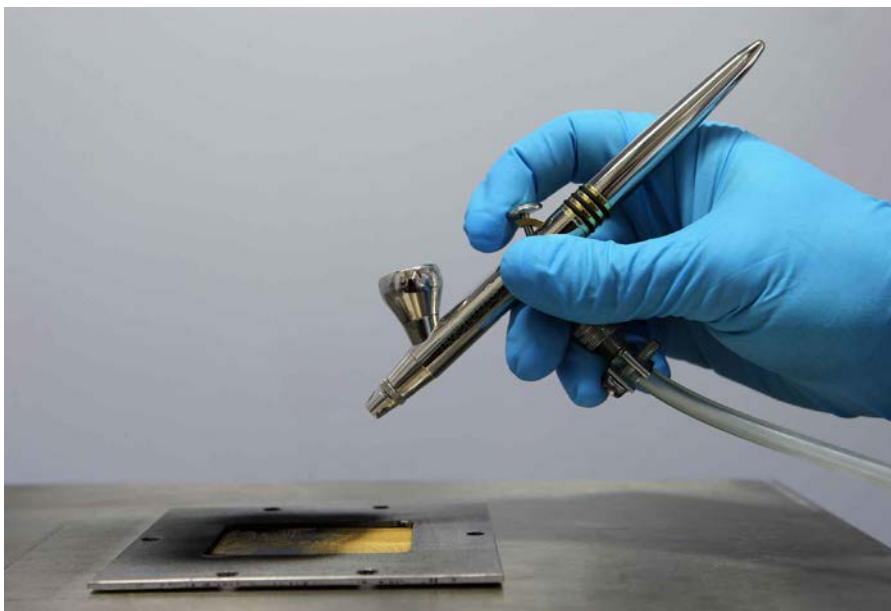
Manueller Sprühprozess zur Herstellung von Gasdiffusionselektroden im Labor. Diese können CO 2 direkt elektrochemisch umsetzen und so Synthesegas und andere wichtige Grundstoffe für die chemische Industrie bereitstellen.
