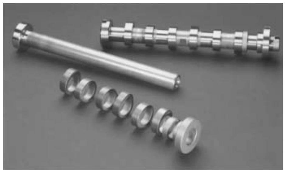
Bild 9: Innenhochdruckgefügte Nockenwelle für einen 3-Zylinder-CDI-Dieselmotor (Prospekt DAIMLER-CHRYSLER)
