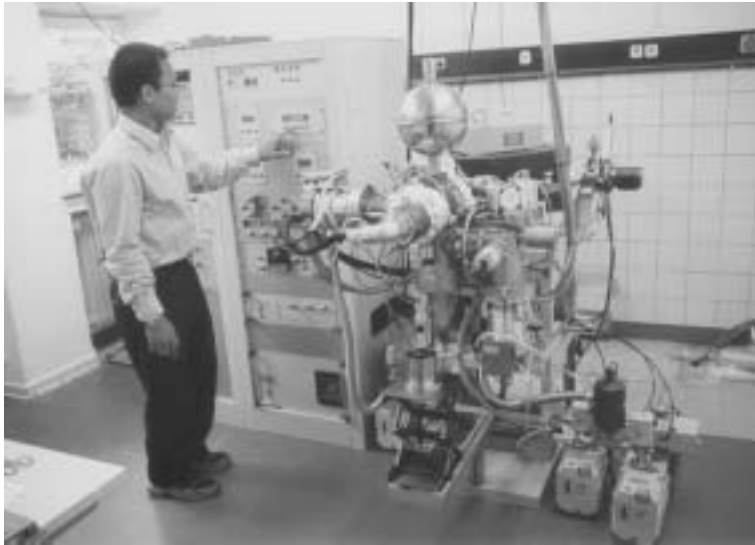
Bild 1: Massenspektrometer mit Knudsen-Zelle a) Gesamtansicht
