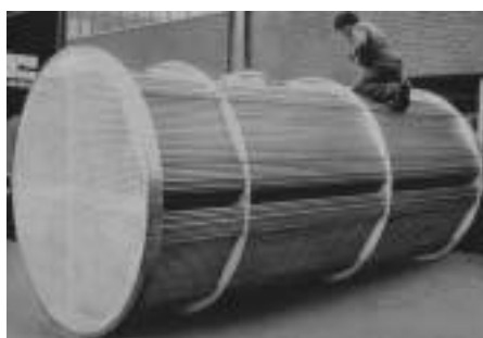
Bild 1: Rohrbündel eines Wärmetauschers (TITZE, WILKE 1992)
