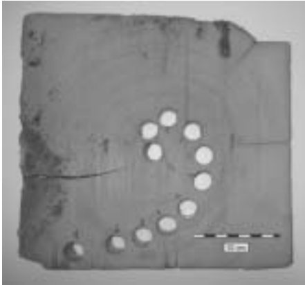
Bild 2: Scheibe des Eichenbalkens aus der Marktkirche zum Heiligen Geist. Die Entnahmepunkte der axialen Proben sind deutlich zu erkennen.
