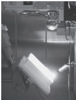
Lasersintern von SiO 2 -Tiegelprototypen für die Solarsiliciumproduktion. Eine Entwicklung mit der Wacker-Chemie GmbH, Burghausen. Foto: Dr. Jens Günster
