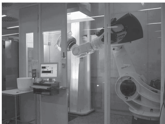
Bild 6: Pilotlinie einer aufgeweiteten \text{CO}_2 -Laserstrahlsinterapparatur im Reinraum
